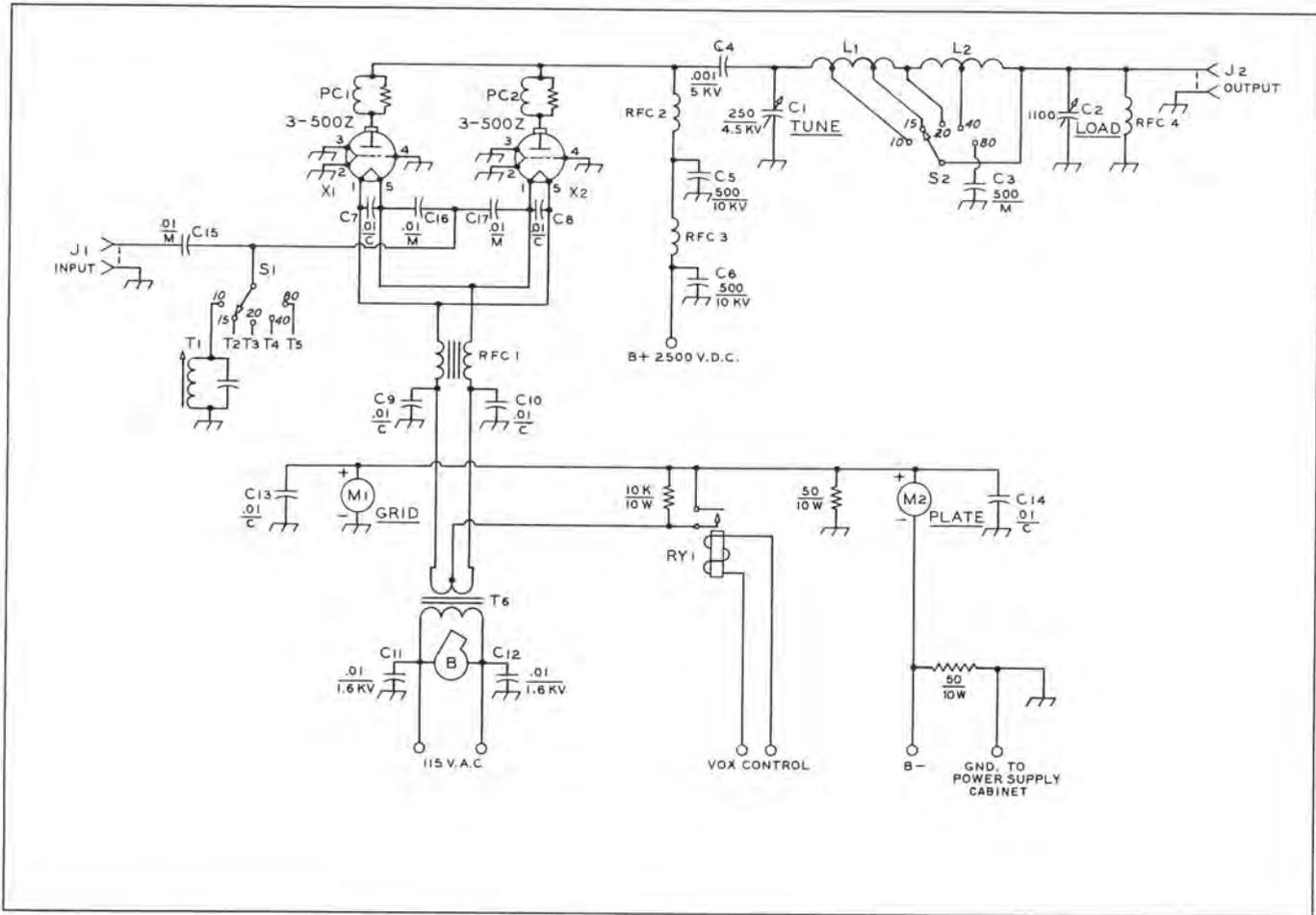
**TYPICAL CATHODE DRIVEN (GROUNDED GRID) AMPLIFIER CIRCUIT FOR TWO 3-500Z TUBES**
